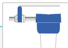
Con válvula antirretorno en la salida
